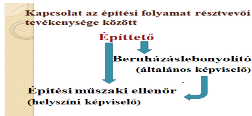
Az építtető képviselői az építési folyamatban
