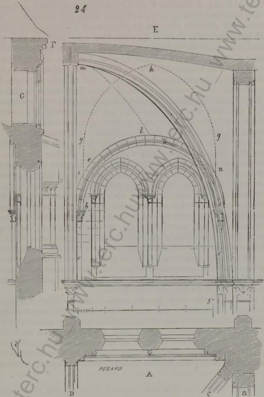
En E, est tracée la coupe, suivant le grand axe, de cette portion de voûte. Les colonnettes *c* existent encore en place avec leurs chapiteaux, et dans les travées du chœur les branches *be* d'arcs formerets ont été laissées au-
